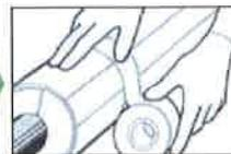
③300mm~400mmの間隔で円周方向にアルミバンドを取り付けてください。(目安: 1mに2ヶ所)中央と継ぎ目部にアルミガラスクロステープを巻き、手で数回強く圧着して下さい。2巻き以上が最適です。
