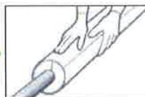
②更にヒレと本体表皮部の接合面の長手方向にアルミガラスクロステープを貼り、手で数回強く圧着して下さい。
