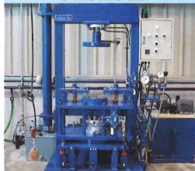
水圧検査装置
