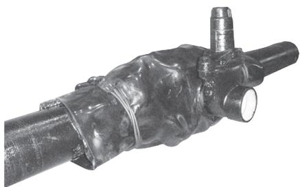
防食ゴムは、耐熱・耐寒・耐電・耐水性に非常に優れ、被覆埋設することにより、土圧によって管に密着し空気、水、電位差からの隔離によって、金属の腐食防止性能を発揮するものです。
