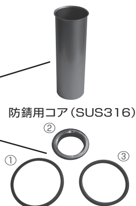
コア固定用パッキン ①フランジリング (合成樹脂) ②固定金具 (SUS316・SBR) ③GF形ガスケット1号 (SBR)
