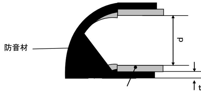
VU : 屋外排水用硬質塩化ビニル管継手 (塩化ビニル管継手協会規格 AS-38)
